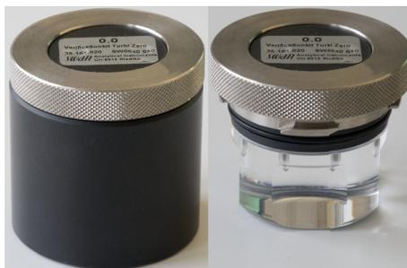
L'unité de test est calibrée pour une température d'échantillon de 25 °C. Si votre échantillon a une température différente de 25 °C, vous devez convertir le point de consigne à la température correspondante. Pour ce faire, la température de l'échantillon doit être mesurée en externe. La variation est de +0,3 à +0,4% par °C. Cela signifie que plus la température est basse, plus la diffusion est faible.
