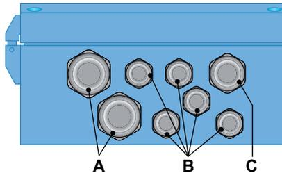
**A** PG 11 cable gland: cable  $\varnothing_{outer}$  5–10 mm
