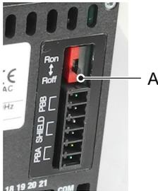
**A** Interrupteur pour la résistance terminale
