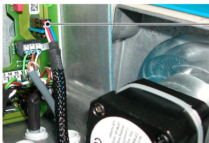
A Conector del motor
