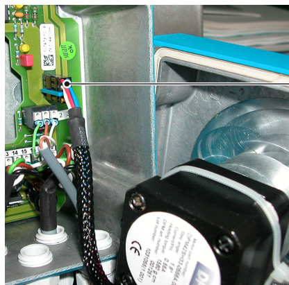
A Connettore del motore
