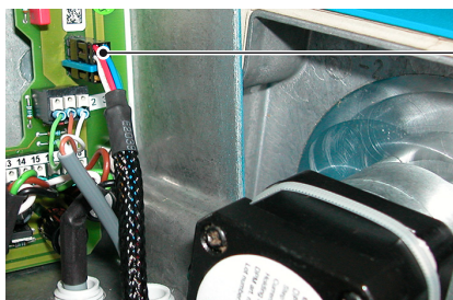
A Conector del motor
