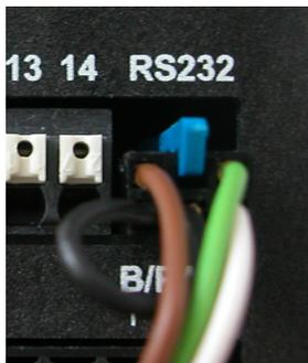
Die RS232-Schnittstelle wird für das Herunterladen des Loggers und zum Hochladen der Firmware verwendet.
