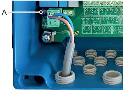
**A** 0.8 AT/250V Stromversorgung Instrument
