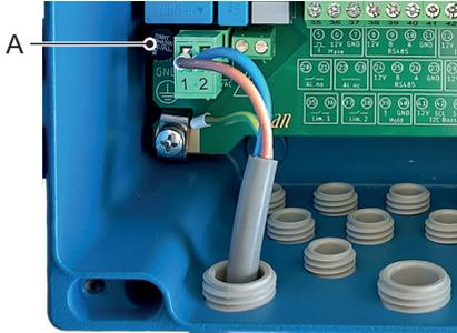
**A** 0.8 AT/250V Stromversorgung Instrument
