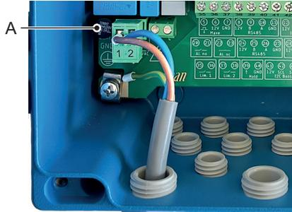
**A** 0.8 AT/250V Stromversorgung Instrument
