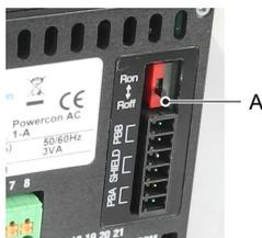
**A** Interrupteur pour la résistance terminale
